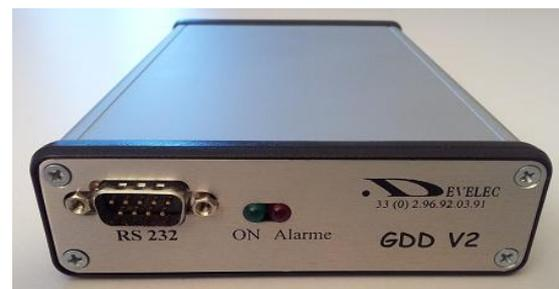
Figure 10 Boîtier d'interface avec report d'alarme autonome
