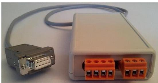
Figure 10 Boîtier interface avec report d'alarme géré par le PC
