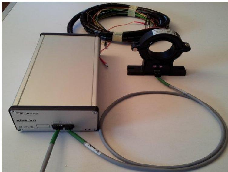
Figure 2 Câbles et cartes de mesures montés en coffret
